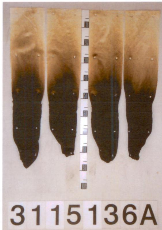
Schädigung der Brandschichtproben:
